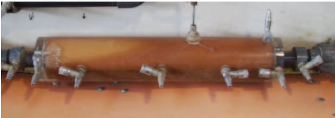
شکل ۵.۵: نمایش بخش انبساط و انقباض ناگهانی
