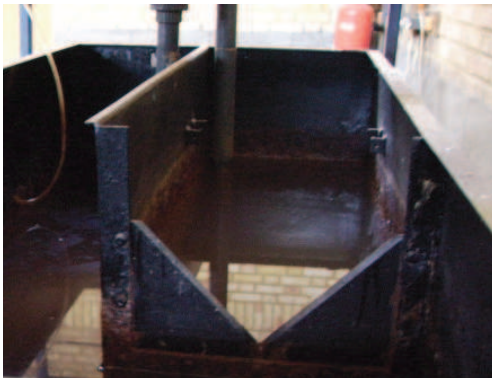
شکل ۷.۱۰: سرریزها از جمله سازه‌هایی مکانیکی هستند که برای تعیین دبی بکار برده می‌شوند.
