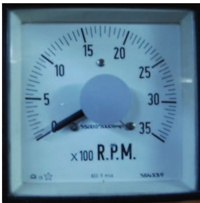
شکل ۵.۱۰: برای نمایش دور الکتروموتور از دورسنج استفاده می‌شود.
